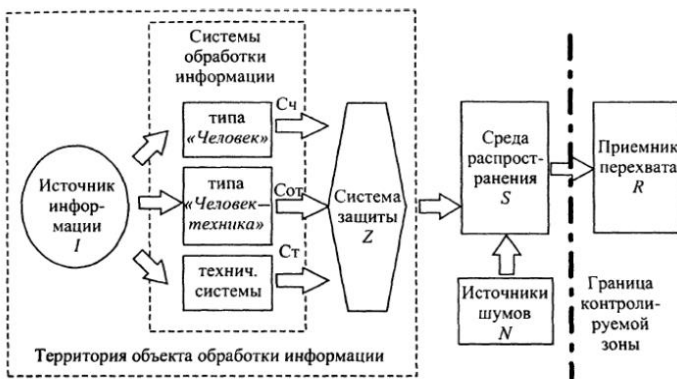
Рис. 5 Модель канала утечки информации
